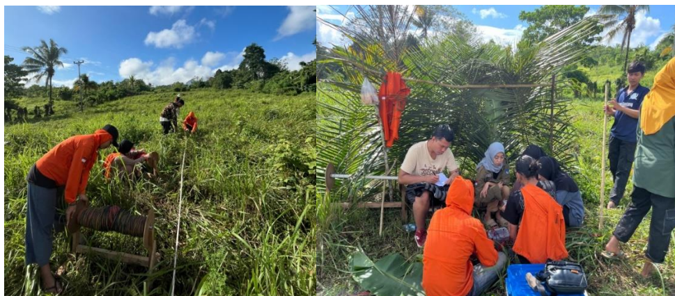
Gambar 4. Pengukuran Geolistrik untuk Pencarian Sumber Air Tanah
