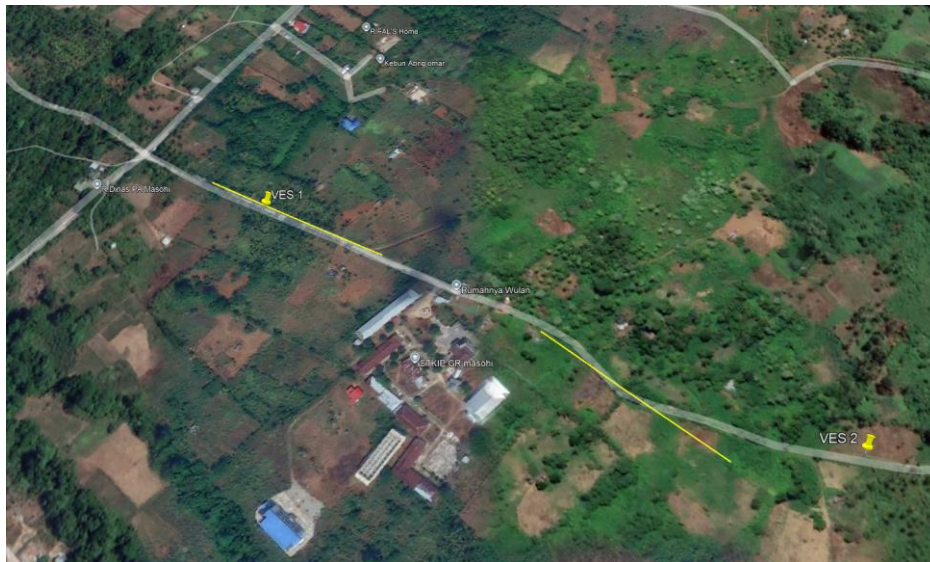
Gambar 3. Lokasi pengambilan data geolistrik dimana garis merah merupakan lintasan ERT dan titik kuning merupakan titik VES
